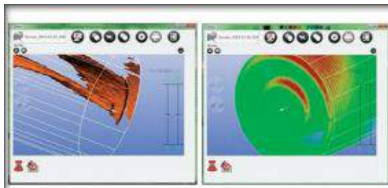
Image 28 : Cartes 3D obtenues par la tête de sondage grâce à la technologie ORFEUS[37]
