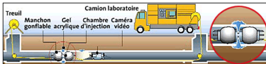
Image 10 : Schéma d'étanchement de canalisation par injection 8
