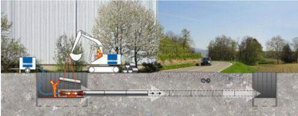
Image 4 : Pousse tube par battage 4
