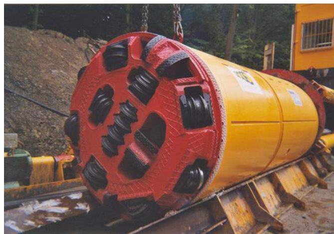
Annexe 3 : roue de coupe d'un microtunnelier équipée de molettes
