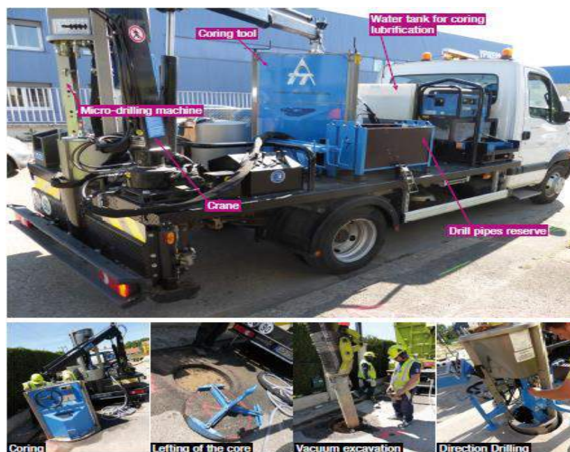
Image 26 : engin tracto-technik permettant de réaliser la technique de micro-forage : Keyhole [34]
