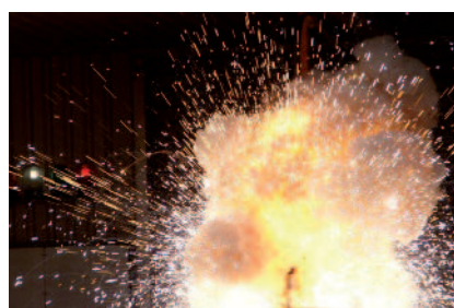
Arc électrique 7 kA
