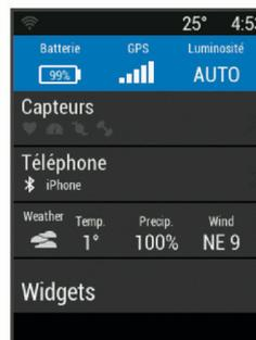
La page d'état s'affiche. Une icône clignotante signifie que l'appareil recherche un signal. Une icône fixe signifie que le signal a été trouvé ou que le capteur est connecté.
