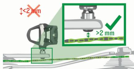
**REMARQUE :** Garmin recommande au moins 2 mm entre la pédale et la chaîne. Si la pédale frotte contre la chaîne, vous pouvez ajouter une rondelle (fournie) entre l'axe de pédale et la manivelle pour augmenter l'écart entre les deux. Pour que le facteur q soit égal, vous pouvez ajouter une rondelle sur l'axe de la pédale gauche. N'utilisez pas plus d'une rondelle sur chaque pédale.
