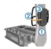
**4** Faites tourner la manivelle pour vérifier le dégagement. Le capteur et les sangles ne doivent pas entrer en contact avec les pièces de votre vélo ou votre chaussure.
