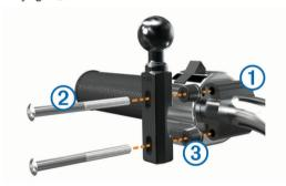
**REMARQUE**: des boulons standard de 1/4 po et des boulons M6 sont fournis avec le produit. Utilisez des boulons de même taille que les boulons d'origine du levier de frein ou d'embrayage.
