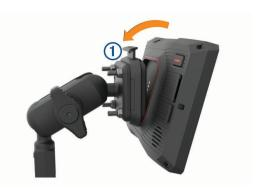
2 Poussez le haut de l'appareil vers l'avant jusqu'à ce qu'il se clipse.
