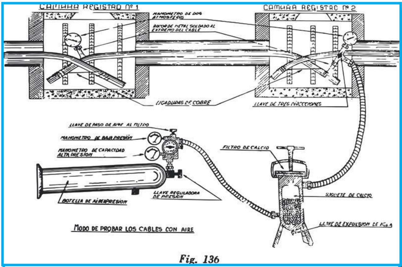
Prueba de detección de fugas de los cables de pares mediante equipo de aire
