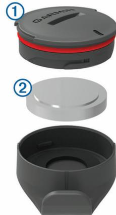
2 Tournez le cache dans le sens inverse des aiguilles d'une montre jusqu'à ce qu'il soit suffisamment desserré pour pouvoir être retiré.
